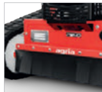
Schutz vor Steinschlag: Wurfkörperprüfung nach DLG
