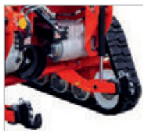
Standard-Dreipunkt-Aufnahme (KAT 1) für hohe Flexibilität unterschiedlicher Anbaugeräte
