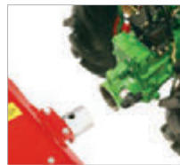
Rohranbauflansch: einfacher und schneller Anbaugerätewechsel
