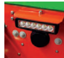
LED-Funktionscheinwerfer mit visueller Warnfunktion
