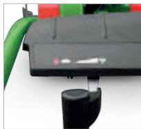
Motordrehzahl vom Lenkholm aus einstell- bar
