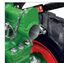
Zusätzliche Aufnahme für gezogene Geräte, z. B. Pflüge
