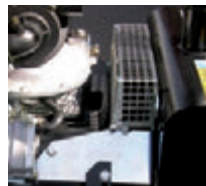
Optimierte Luftansaugung schützt den Motor vor Überhitzung
