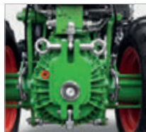
agria-Anbauflansch: einfacher und schneller Anbaugerätewechsel
