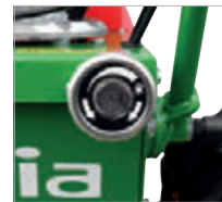
Stufenloses Einstellen der Bürstendrehzahl
