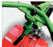
Werkzeuglose Seitenverstellung des Lenkholms mit Schnelleinstellhebel
