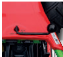
Sicheres Abstellen der Maschine mit zentraler Feststellbremse
