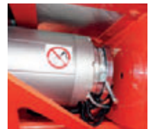
Sicherheit am Hang dank elektromechanischer Bremse
