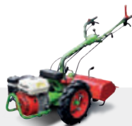
Lenkholm um 180° drehbar
