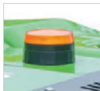
LED-Signalleuchten zur besseren Erkennbarkeit und zur Anzeige der Fahrtrichtung
