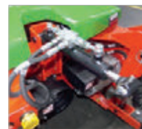
Hydraulischer Oberlenker, Neigungswinkel des Anbaugerätes ist über Fernbedienung einstellbar
