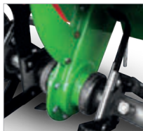
Robustes und langlebiges Kettengetriebe im Ölbad
