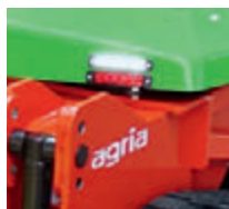
LED-Signalleuchten zur Anzeige der Fahrtrichtung
