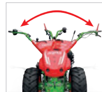
Lenkholm in beide Richtungen seitlich schwenkbar
