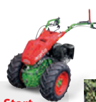
Portalachse zur Schwerpunktverstellung
